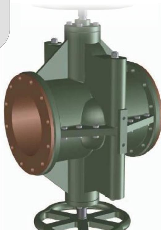
Estas válvulas se utilizan para los mismos fines que las válvulas con mando de cierre, pero su diseño es diferente de estas últimas porque la válvula está equipada con un cilindro hidroneumático de doble acción para las operaciones de apertura y cierre.
