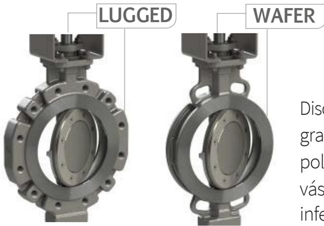
Disco flotante, asiento en el disco, disco gemelo para grandes diámetros (mayor Cv), unión del vástago poligonal (para alto torque y alto ciclaje), sellos del vástago precargados, doble prensaestopas (superior e inferior), anti blowout.
